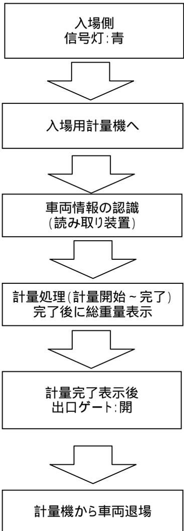
灰搬出車両、資源物搬出車両等も自動計量の対象とする。
