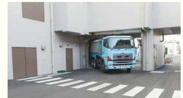
焼却灰や飛灰は灰運搬車で最終処分場まで運び、埋め立てます。灰運搬車は灰が漏れないよう特別な造りになっており、天蓋等がついています。
